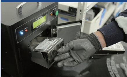
磁気破壊による消去
