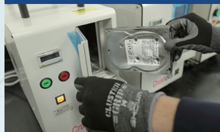
HDDクラッシャー(穿孔機)による物理破壊
